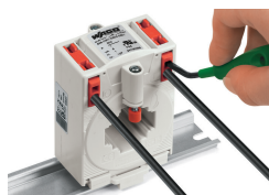
Vezeték bekötése – csavarhúzóval, pár- huzamosan a vezeték bekötésének irányával
